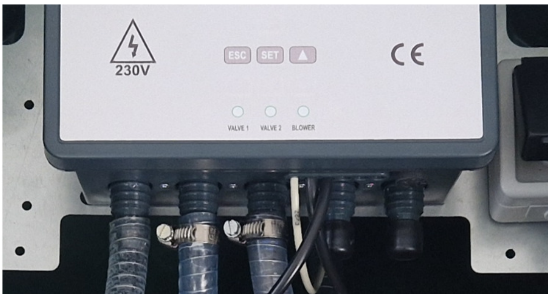
18.attēls. Tastatūra un indikācijas diodes, kas attēlo vadības bloka izeju darbības stāvokļus.
