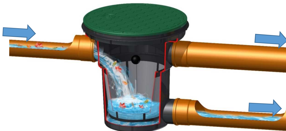
Rysunek 12: Filtr przelewowy do wody deszczowej D400 AQ – schemat działania.
