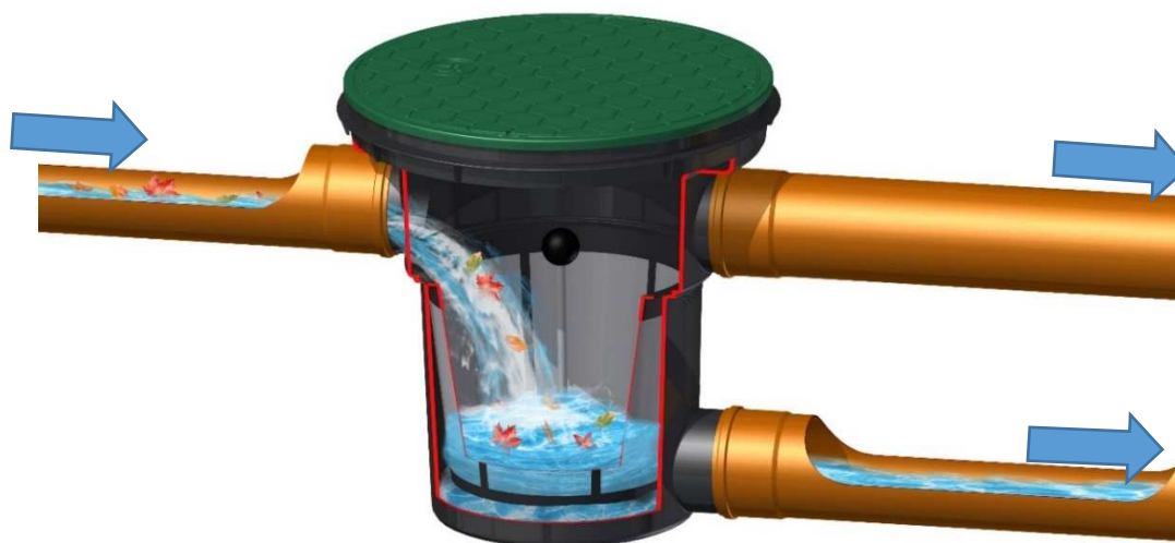
Rysunek 12: Filtr przelewowy do wody deszczowej D400 AQ – schemat działania
